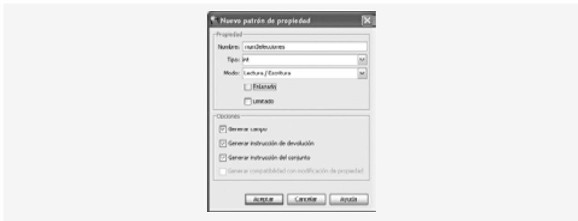
Figura 26.27 | Cuadro de diálogo Nuevo patrón de propiedad para agregar una propiedad al objeto SessionBean .
